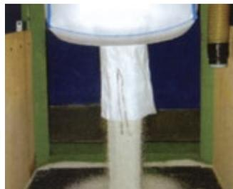
Bocca inferiore con valvola di scarico
