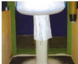
Bocca inferiore con valvola di scarico
