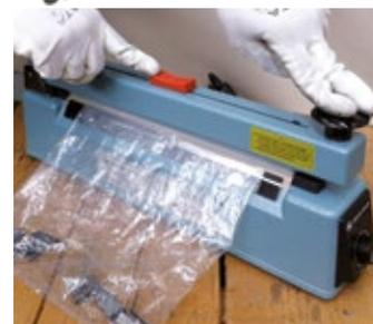
Con queste saldatrici potrete eliminare l'eccedenza del sacchetto oltre la saldatura oppure produrre sacchetti della misura desiderata utilizzando film tubolari
